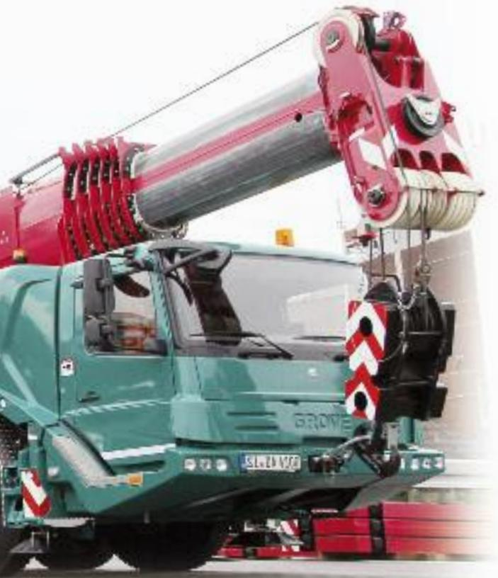
einem klassischen Halleneinsatz, ein 82 t schweres Maschinenteil bei einer Ausladung von 6,50 m anzuheben. Die Halle selbst verfügte dabei allerdings nur über eine lichte Höhe von rund 10 m.
