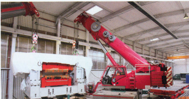
Eine Version des GMK4100 mit kürzerem Hauptausleger – perfekt für Hubarbeiten in Gebäuden.
